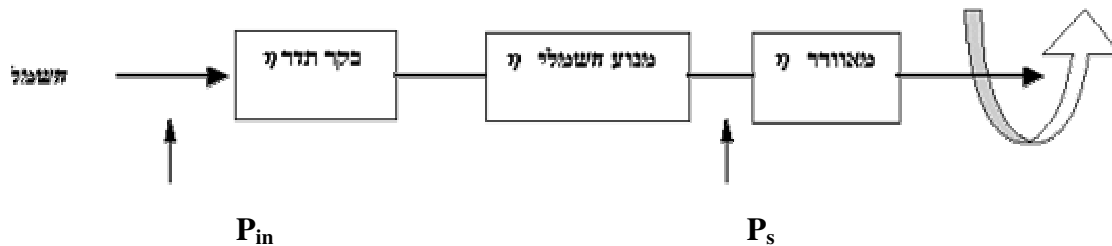
איור 1. סכימה עקרונית של חיבור מאוורר לחשמל דרך בקר סיבובי מנוע.
